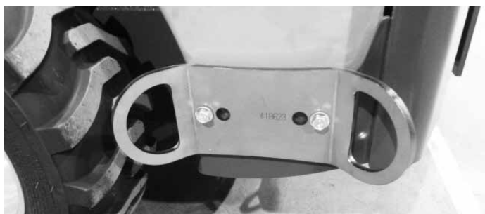
Az A418623 lekötöző tartóelem a hátsó vázrész oldalánál van felszerelve Oldalsó felszereléshez két lekötöző tartóelemre van szükség.
